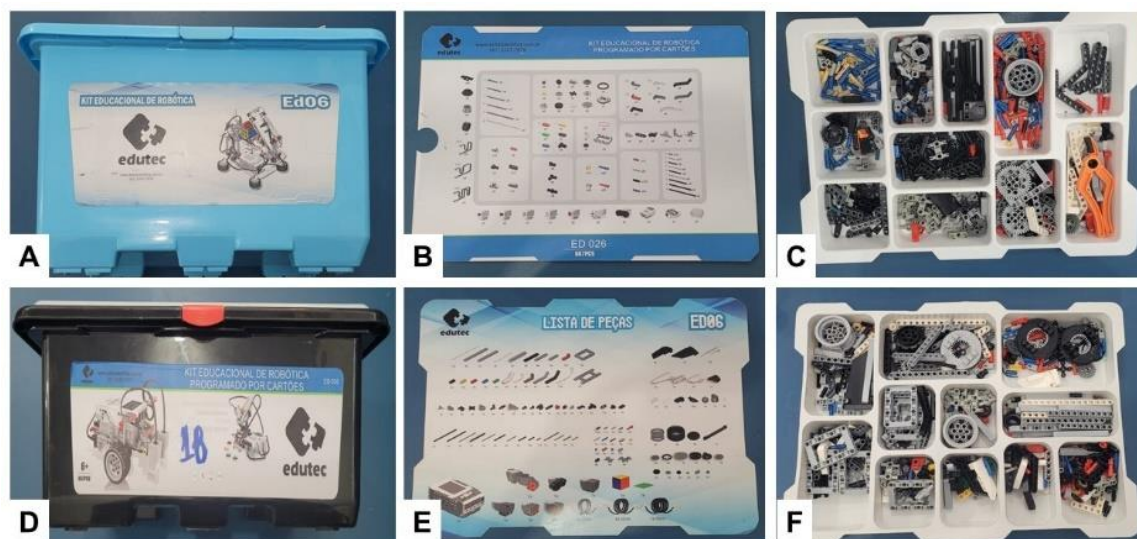
Figura 02. Kits de montagem de Robótica Educacional. A) Caixa do Kit ED06. B) Ficha das peças disponíveis no Kit ED06. C) Mostruário das peças da Kit ED06. D) Caixa do Kit ED26. E) Ficha de peças disponíveis no Kit ED26. F) Mostruário de peças da caixa ED26.
