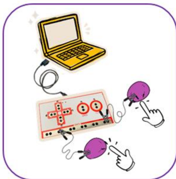
Figura 1: Configuração do Makey Makey
