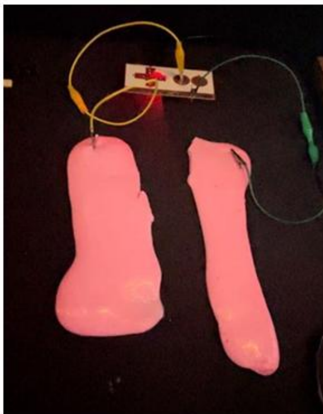
Figura 5: Projeto "Condutor ou isolante?" com Makey Makey
